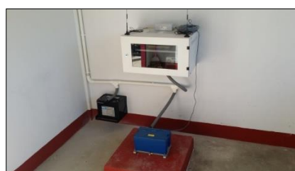
รูปที่ 5.2.5 – 3 อุปกรณ์รับส่งข้อมูลแผ่นดินไหว ผ่านระบบสัญญาณอินเทอร์เน็ต และระบบพลังงาน และอุปกรณ์ตรวจวัดค่าอัตราเร่งของพื้นดิน (Accelerograph)
