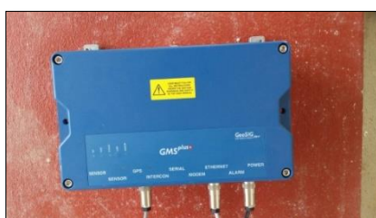
รูปที่ 5.2.5 – 3 อุปกรณ์รับส่งข้อมูลแผ่นดินไหว ผ่านระบบสัญญาณอินเทอร์เน็ต และระบบพลังงาน และอุปกรณ์ตรวจวัดค่าอัตราเร่งของพื้นดิน (Accelerograph)
